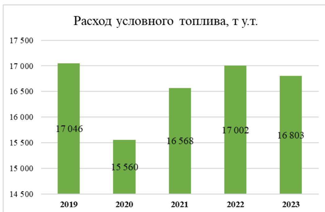
**Рисунок 60 – Расход условного топлива на котельной «Роста»**
