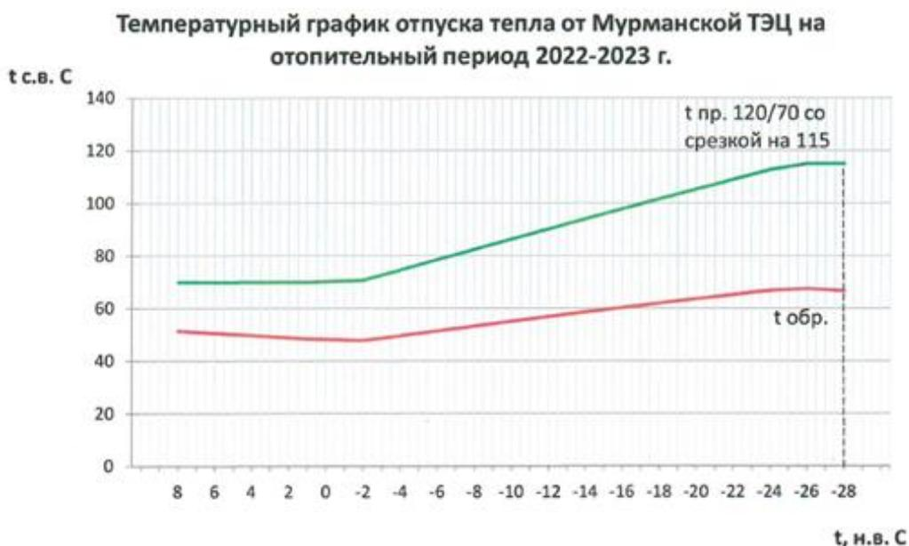
Температурный график отпуска тепловой энергии от Мурманской ТЭЦ качественного регулирования, 120-70 °С, со срезкой по подающей 115 °С разработан с учетом ограниченной мощности источника при температурах наружного воздуха ниже -26 °С.
