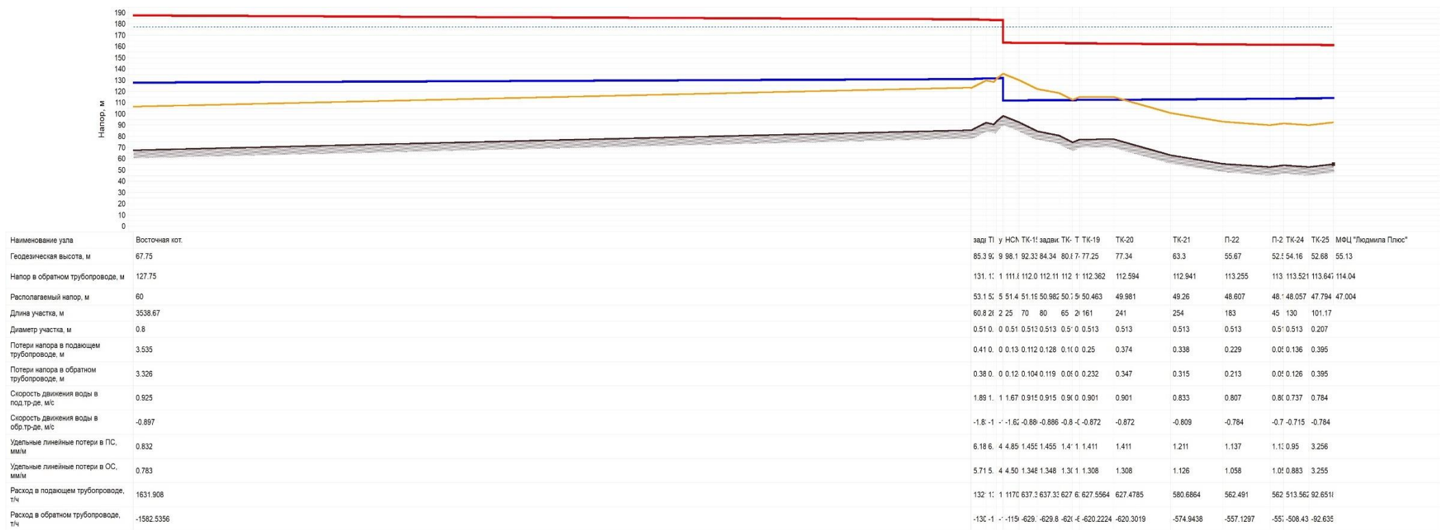
Рисунок 4.10 - Пьезометрический график участка тепловой сети от Восточной котельной 13 до перспективного потребителя по ул Рогозерская
